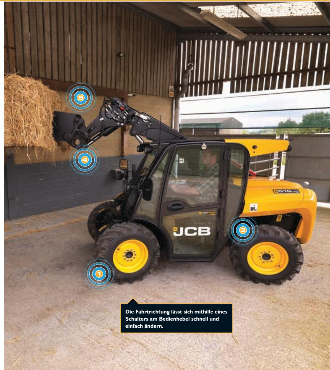
Die Fahrtrichtung lässt sich mithilfe eines Schalters am Bedienhebel schnell und einfach ändern.
