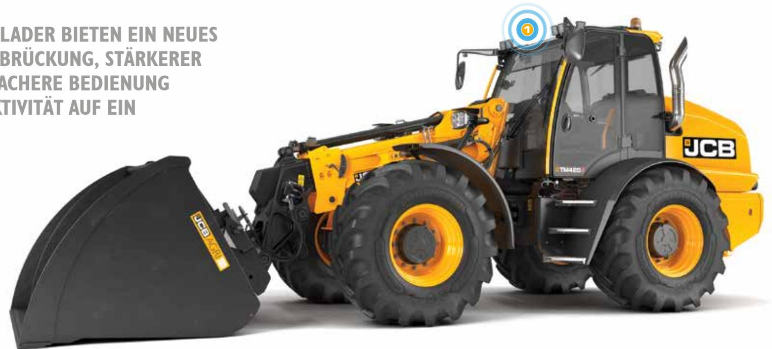
**4** Der TM420 und der TM420S sind mit einer innovativen regenerativen Hydraulik ausgestattet. Dies verbessert die Kraftstoffnutzung zusätzlich. Die Schwerkraft wird eingesetzt, um das Absenken und Einfahren des Auslegers so effizient wie möglich zu machen. Auf diese Weise kann der Ausleger in weniger als fünf Sekunden eingefahren und abgesenkt werden.
